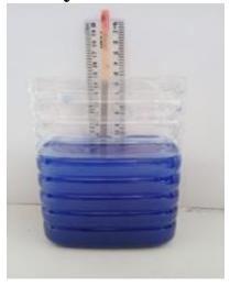
Когда атмосферное давление повысится, уровень воды в бутылке упадет, а в трубке поднимется. И наоборот, при уменьшении атмосферного давления вода поднимется в бутылке и опустится в трубке.
