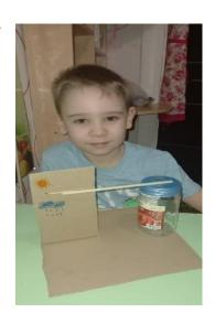
Барометр работает за счет того, что при высоком атмосферном давлении воздух давит на шарик, он проседает, в результате чего свободный конец соломинки с указателем приподнимается. При низком атмосферном давлении на шарик усиливается давление воздуха из банки, он приподнимается, а стрелочка опускается.
